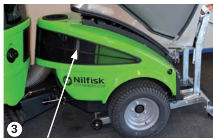
Spínač start/stop – za levým zadním krytem.
