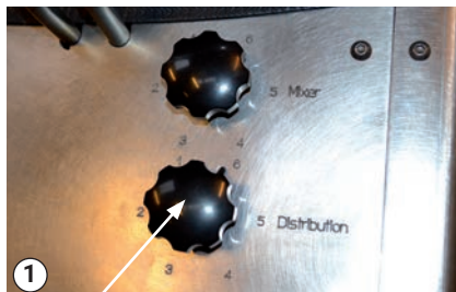
Nastavení šířky posypu – páčka „Distribution“
