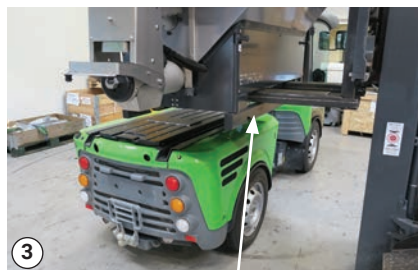
Zvednutí sypače ze základního stroje
