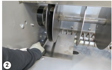
Povolte a odstraňte 3 šrouby a namontujte solnou záračku zasunutím ze strany
