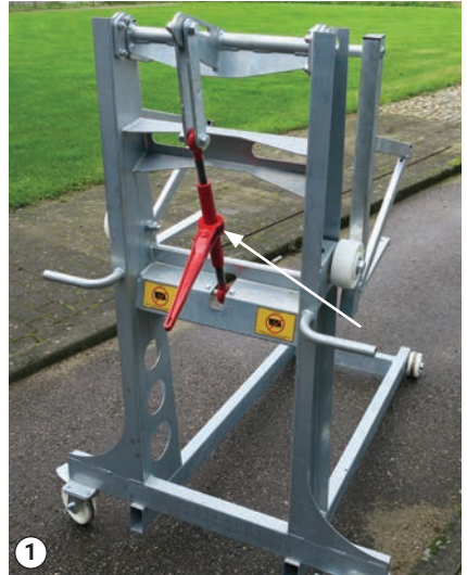
Otevřená/zavřená poloha přepínače nosiče nákladu s ráčnou
