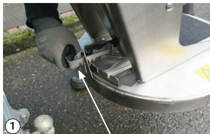
Nastavte posuvnou vodicí rukojeť pro správný materiál
