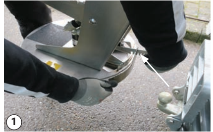
Nastavte páku na asymetrické rozmetání
