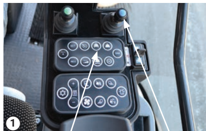
Tlačítko odpružení břemene a pravý joystick
