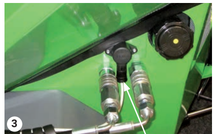
Nainstalujte hydraulické hadice a zástrčku
