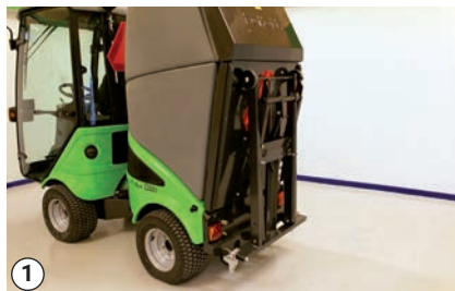
Přeprava rámu zásobníku na zásobníku
