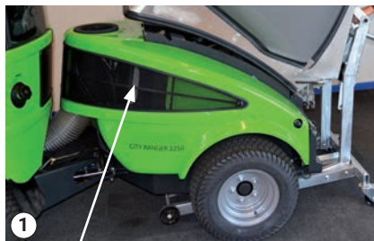
Funkce spuštění/zastavení - za levým zadním krytem
