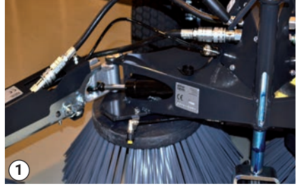
Hydraulické a vodní hadice na rámu A jsou připojeny
