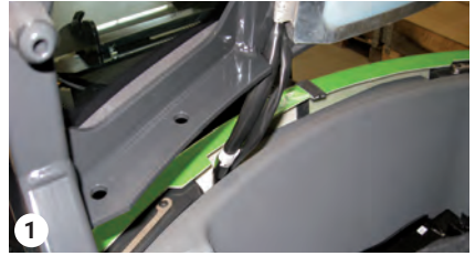
Leitungen nach unten ziehen
