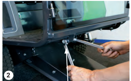
Bolzen unter der Bodenplatte
