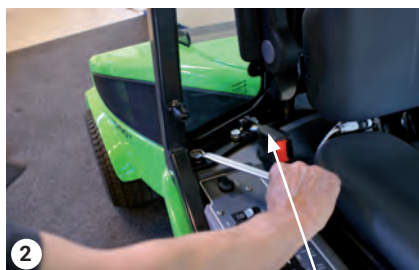
Bolzen entfernen, 2 auf jeder Seite
