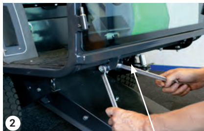
Bolzen unter der Bodenplatte
