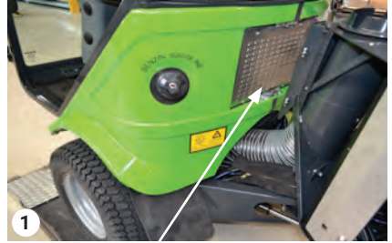
Kabinen-Luftfilter hinter dem Gitter
