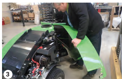
Abbau der Seitenverkleidungen
