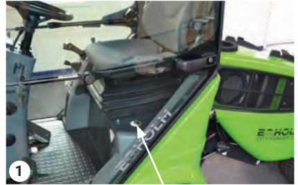
Regulierung der Heizung
