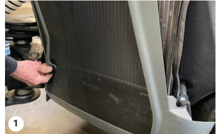
1 Zugang zu Kühler und Verflüssiger
