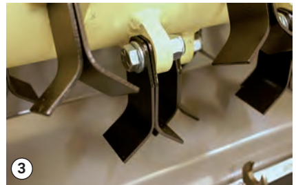
Die Schlegelmesser werden paarweise angebracht.
