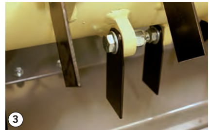
Die Vertikutiermesser sind einzeln einzusetzen.
