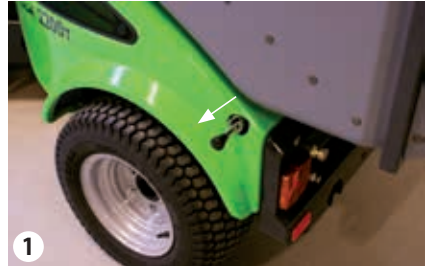
Hebel der Verriegelung herausziehen
