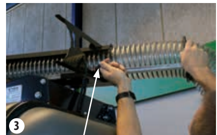
Schraube lösen, herausziehen und wieder festziehen.
