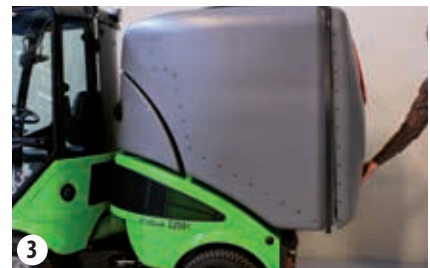
Schließen der Heckklappe
