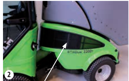
Reinigung des Kühlgitters der Maschine
