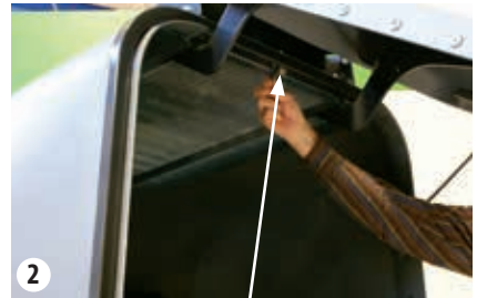
Filtergitter hinten lösen
