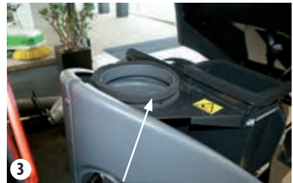
Mit Kabelbindern befestigter Dichtungsring
