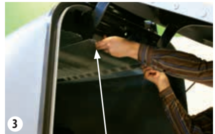
Filtergitter nach hinten herausziehen
