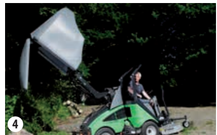
Grassammelbehälter in max. angehobener Position und ganz nach hinten gekippt
