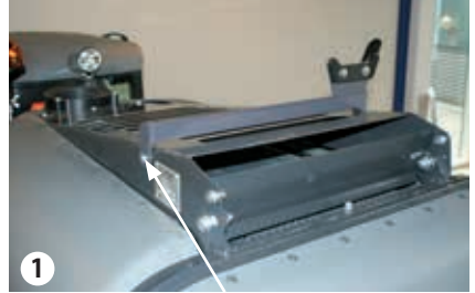
An Schraubenköpfen drehbar befestigte Transportverriegelung
