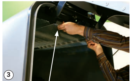
Filtergitter nach hinten herausziehen
