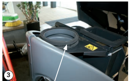
Mit Kabelbindern befestigter Dichtungsring
