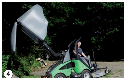
Grassammelbehälter in max. angehobener Position und ganz nach hinten gekippt
