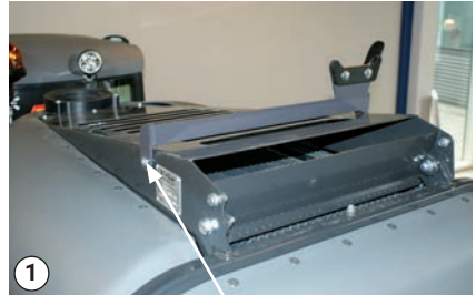
An Schraubenköpfen drehbar befestigte Transportverriegelung
