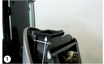
Austausch Dichtung an der Turbine
