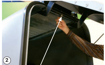
Filtergitter hinten lösen
