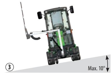
Gelände mit mehr als  $10^\circ$  Neigungswinkel darf nicht befahren werden
