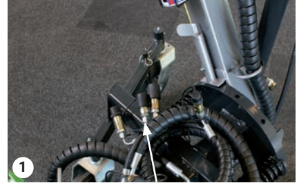
Reinigen der Anschlüsse
