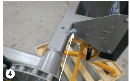
4 Innensechskantschraube anziehen. Sicherstellen, dass sich das Messer nicht aus dem Vierkantrohr des Schneidauslegers bewegen lässt.
