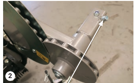
2 Innensechskantschraube zeigt nach rechts
