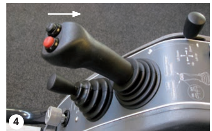
4 Joystick nach hinten ziehen
