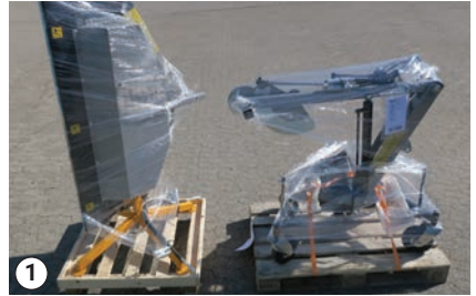
Ausleger und Trimmer werden auf zwei Paletten geliefert
