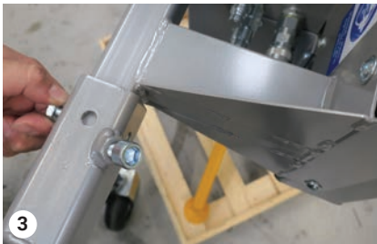
3 Den Trimmer in der Vierkantbohrung montieren, M10 Schraube
