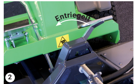
Verriegelung am Frontkuppeldreieck (unverriegelt)
