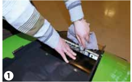
Die Kupplungen mit einem Tuch reinigen
