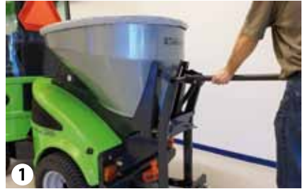
Absenken des Salz- und Kiesstreugeräts auf den Geräteträger
