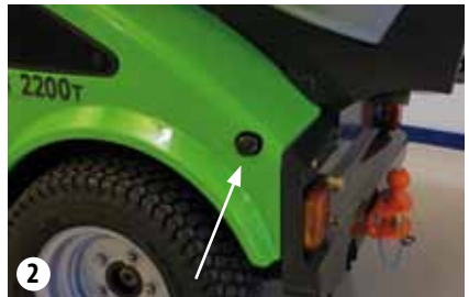
Hebel der Verriegelung herausziehen
