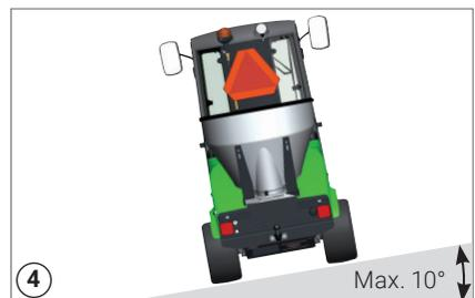
Gelände mit mehr als  $10^\circ$  Neigungswinkel darf nicht befahren werden.
