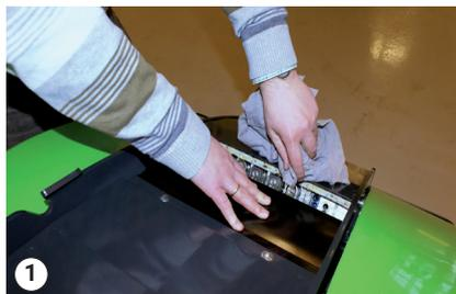
Die Kupplungen mit einem Tuch reinigen
