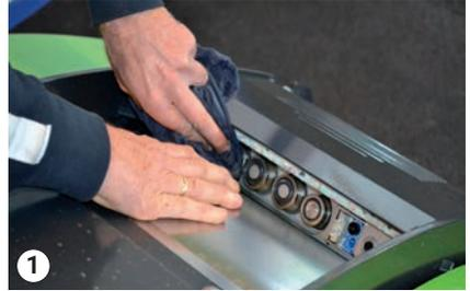
Die Kupplungen mit einem Tuch reinigen
