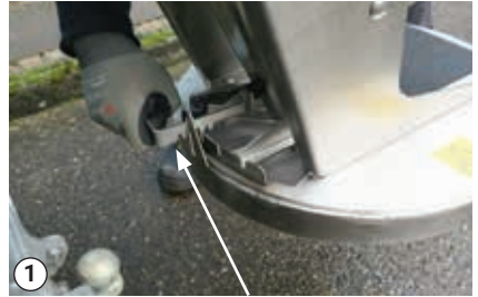
Passen Sie den Griff der Schlittenführung für das richtige Material an
