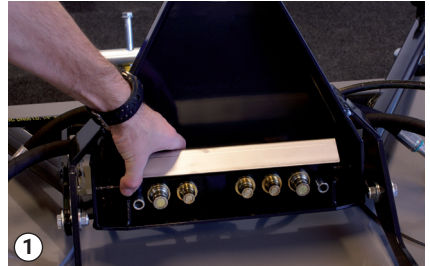
Reinigen Sie die Schnappkupplungen
