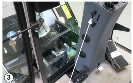
Anbringen der Transportsicherungen
