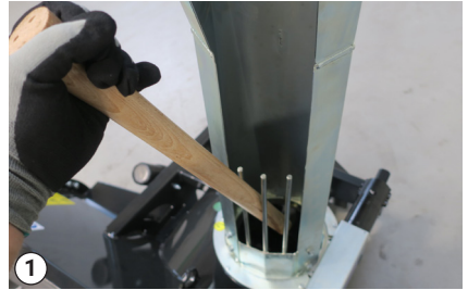
Verwenden Sie den Holzstab, um den Auswurfschacht freizumachen.
