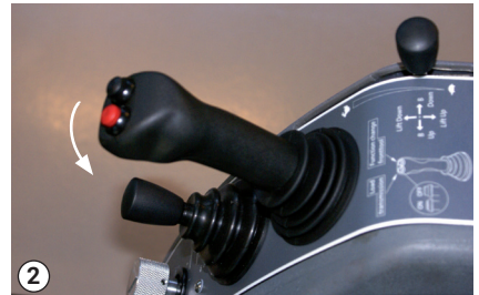
Einstellung des Hebels zum Bewegen des Auswurfschachts nach links
