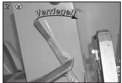
Das Schneeräumschild durch die Transportsicherung verriegeln
