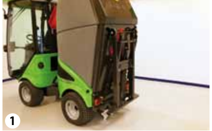
Transport der Abstellstütze am Kehrgutbehälter
