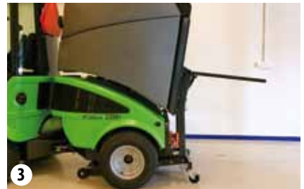
Aufsetzen des Kehrgutbehälters
