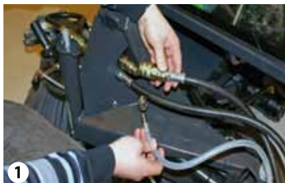
Montage der Hydraulikschläuche + Wasserschläuche am Frontkuppeldreieck
