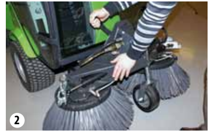
Das Anbaugerät zum Geräteträger kippen
