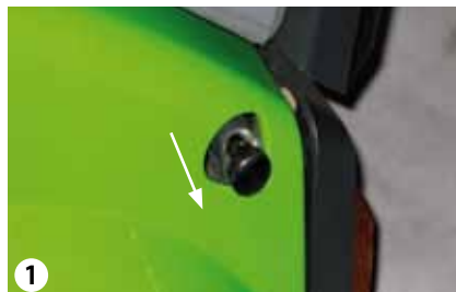
Hebel der Verriegelung herausziehen
