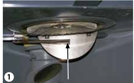
Überprüfung des Rotationsfilters und der Turbine
