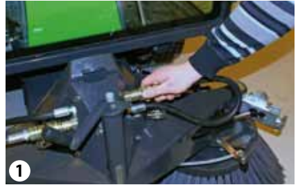
Den Hydraulikschlauch abnehmen
