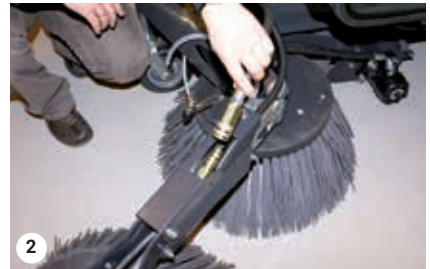
Montage der Hydraulikschläuche + Wasserschläuche am Seitenbesen
