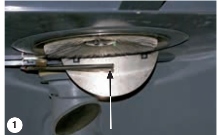
Überprüfung des Rotationsfilters und der Turbine
