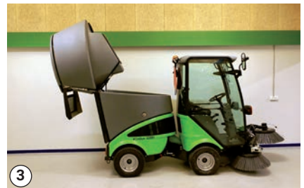
Ganz nach hinten gekippter Kehrgutbehälter
