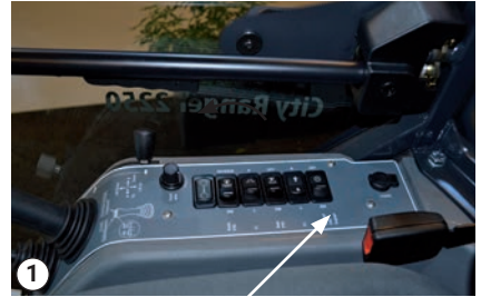
Schalter – Sicherheitsschalter, der eine unbeabsichtigte Inbetriebnahme verhindert
