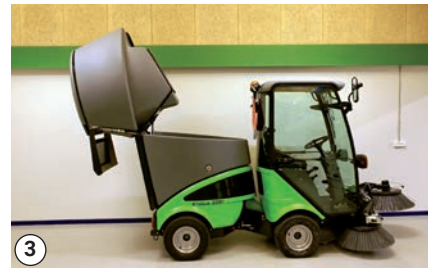
Ganz nach hinten gekippter Kehrgutbehälter
