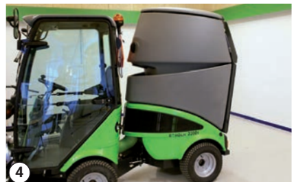
Absenken des Kehrgutbehälters
