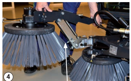
Seitenbesen einrasten lassen
