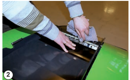
Reinigung der Kupplungen
