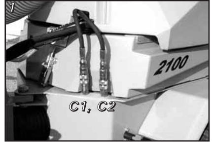
Hydr. schläuche vom Kehrgutbehälter anstecken
