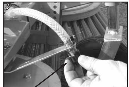
Wasserdüsen vorne an den Frontbesen
