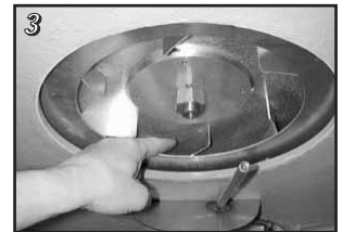
Kontrolle der Turbine
