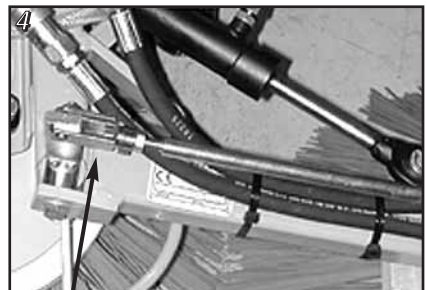
Beschlag zur Winkeleinstellung des Seitenbesens
