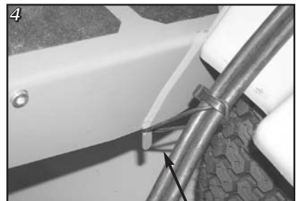
Schläuche werden mit einer Gummischlaufe befestigt.
