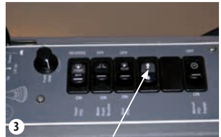
Schalter F2, verriegelte Position
