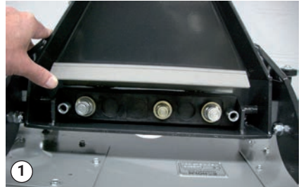
1 „Kupplungen mit einem Tuch reinigen“
