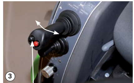
Schwarze Taste betätigen und nach links oder rechts steuern
