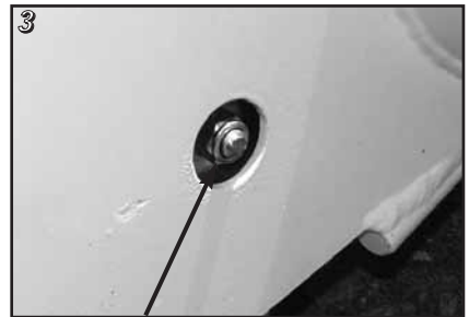
Den Bolzen lösen, der die Kehrwalze festhält
