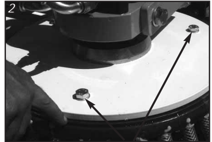
Bolzen, die die Stahlbürste festhalten
