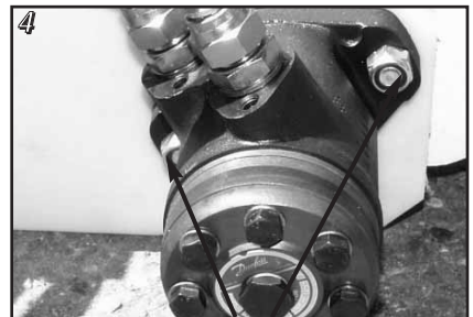
Die Bolzen lösen, die den Ölmotor festhalten
