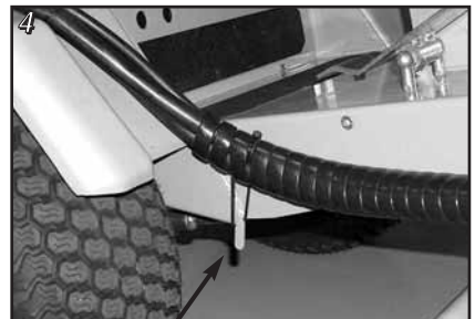
Schläuche mit einer Gummischlaufe befestigen
