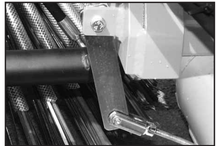
2-3 mm Abstand zwischen Metall und Kuppeldreieck
