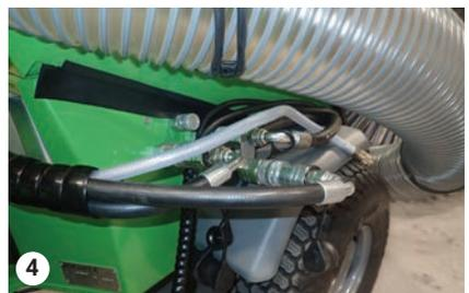
4 Montage der Hydraulikschläuche an D-Anschlüssen
