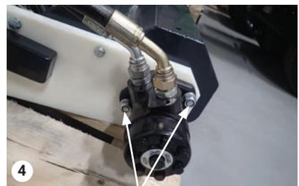
Lösen der 2 Sicherungsmuttern des Ölmotors
