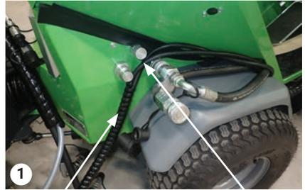
1 Führung der Hydraulikschläuche zwischen den Anschlüssen
