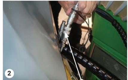
2 Die kleinen Schläuche an der Wildkrautbürste mit den Anschlüssen des Kehrgutbehälters verbinden.
