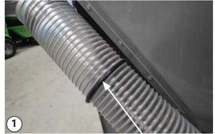
An Saugschlauch montierter Gummiring
