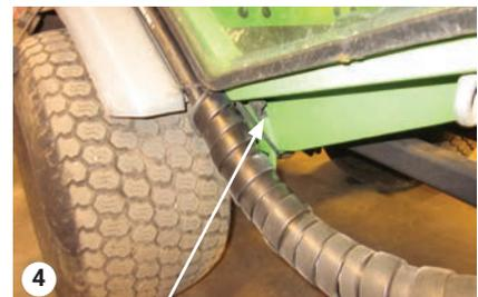
Die Schläuche werden mit einem Gummiband befestigt
