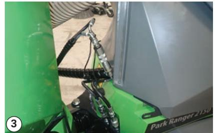
3 Befestigung der Hydraulikschläuche des Kehrgutbehälters am C-Anschluss
