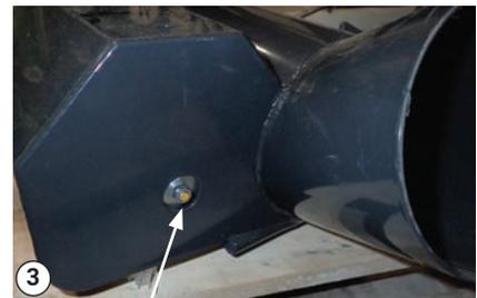
Lösen der Sicherungsschraube der Mittelbürste
