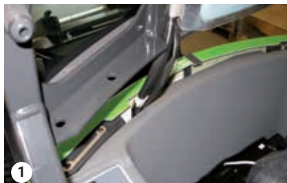
Træk ledninger op
