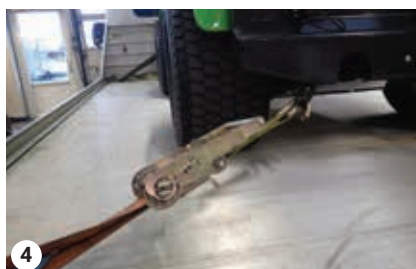
Stropper ved bagenden
