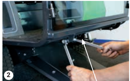
Bolte under bundpladen
