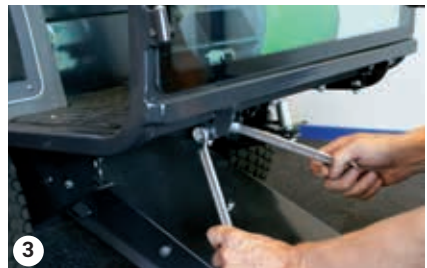
Bolte under bundpladen
