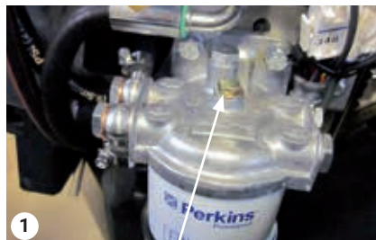
Udluftningsskruen på brændstoffilter
