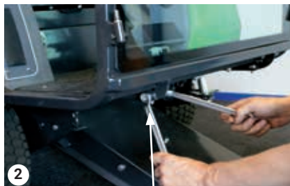
Bolte under bundpladen
