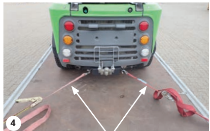
4 Stropper ved bagenden
