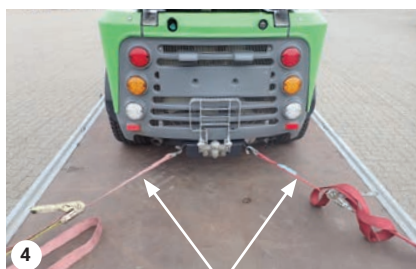
Stroppe ved bagenden
