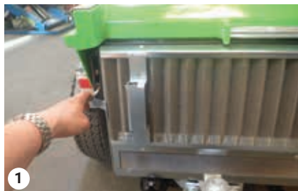
Afmontering af vandkølerskærm
