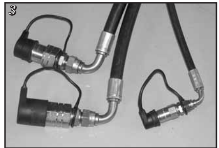
Beskyttelses hætter på koblinger
