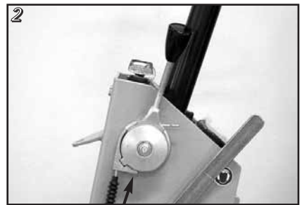
Drej gashåndtaget så det er halvt åbent
