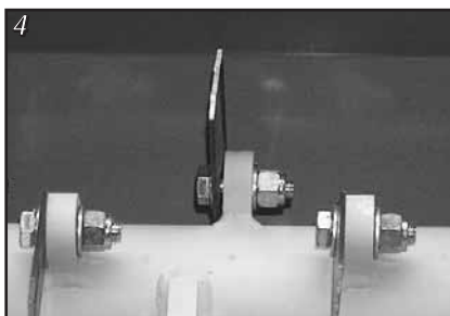
Vertikalknive monteres enkeltvis
