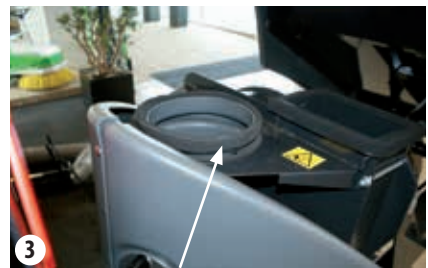
Tætningsring monteret med strips
