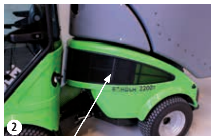
Rensning af kølerist på maskine
