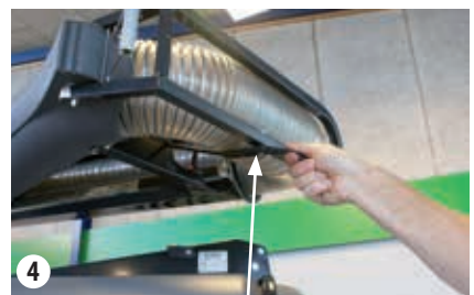
Sæt gummistrop på håndtaget
