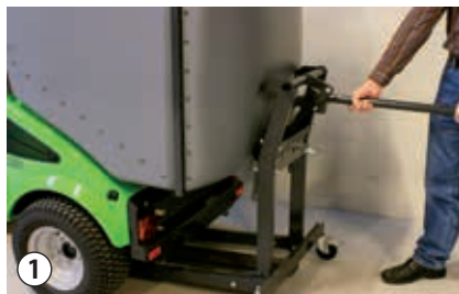
Græsopsamlingstank påsættes maskine
