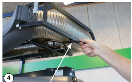
Sæt gummistrop på håndtaget
