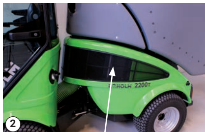
Tænd og sluk funktion bag venstre bagskærm
