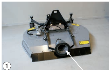
Rensning af tilstopning på rotorklipperen
