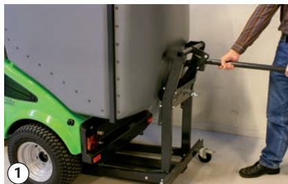
Græsopsamlingstank påsættes maskine
