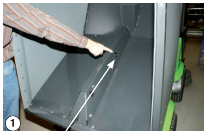
Plastprop ved inspektionshul
