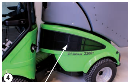
Rensning af kølerist på maskine
