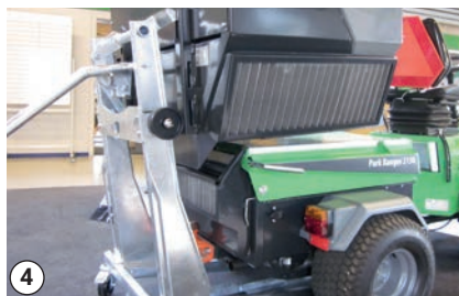
Græsopsamlingstank påsættes maskine
