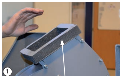
Skift pakning ved turbine
