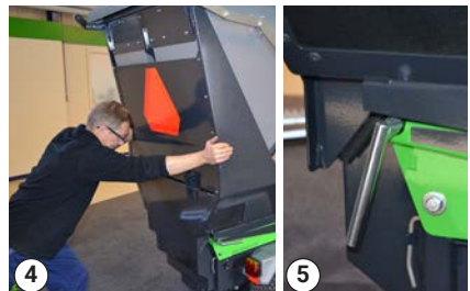
Placer græsopsamlingstanken og lås den fast
