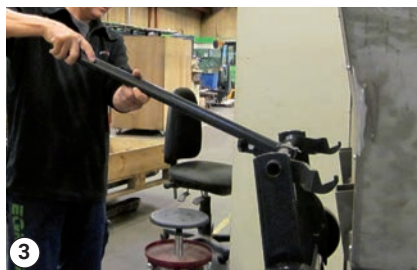
Sænkning af opsamlingstank
