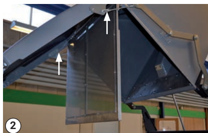
Hængsler på græsfilter
