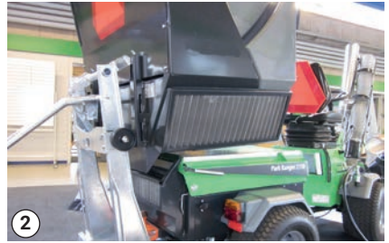
Stativ til af- og påmontering af græsopsamlingstank
