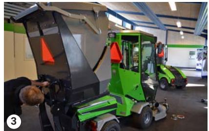
Skub først fremad og sænk så græsopsamlingstanken ned over maskinen
