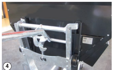
Sæt græsopsamlingstanken på stativ til af- og påmontering af græsopsamlingstanken
