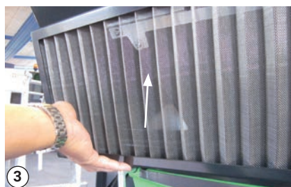
Løft indsugningsfilteret fri
