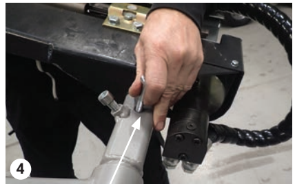
Montér knivbjælken i det firkantede hul, M10-bolt
