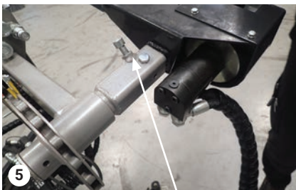
Stram unbrako-bolten. Kontroller, at knivbjælken overhovedet ikke kan bevæge sig fra klippearmens firkantede rør.
