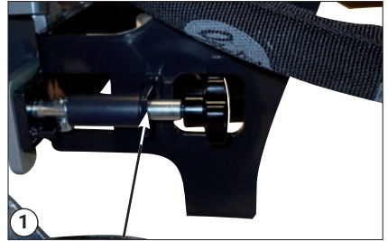
Låsepæl åben - Løvsuger i flydestilling
