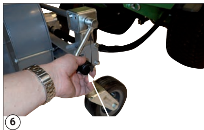
Højdejusteringshåndtag til justering af sugehøjde
