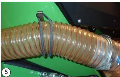
5 Fastgør sugelangen med gummistroppen til maskiner med kabine
