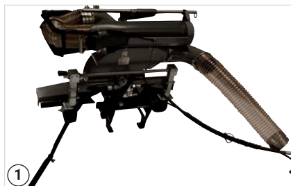
Placer sugeslange og hydraulikslangerne ud til siderne før påmontering
