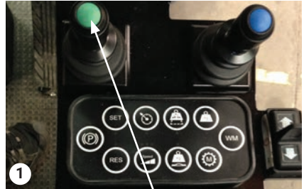
Vip den grønne joystick til højre, venstre eller justér klippehøjden
