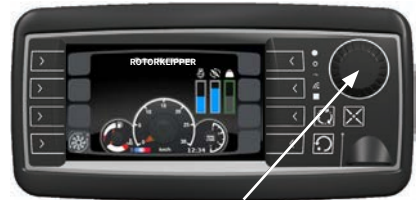
④ Motor omdr/min, skærehastighed, vægtoverførsel kan justeres.
