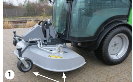
Klipper i højeste position
