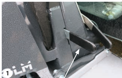
Håndtag i øvre position for vipning.
