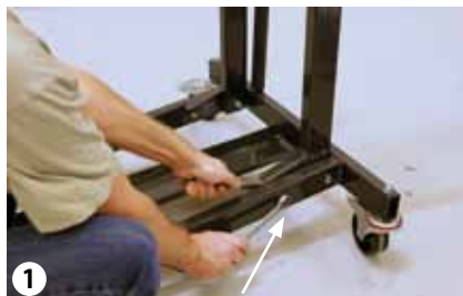
2 bolte på tankstativ
