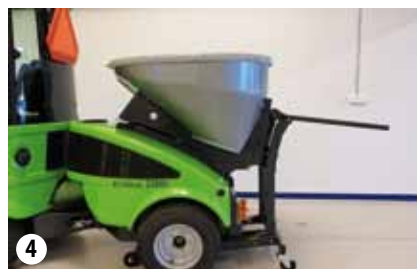
Påsætning af Salt- og grusspreder
