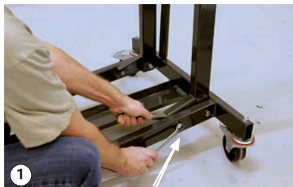
2 bolte på tankstativ
