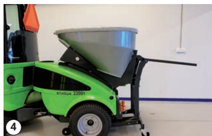
Påsætning af Salt- og grusspreder
