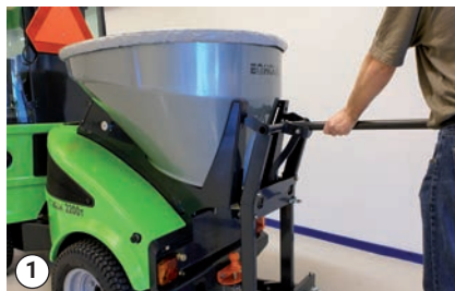
Salt- og grusspreder påsættes maskinen
