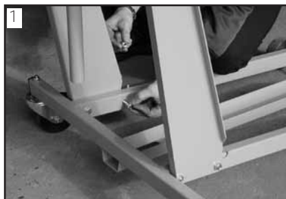
2 bolte på tankstativet
