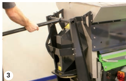
Salt- og grussprederen sænkes
