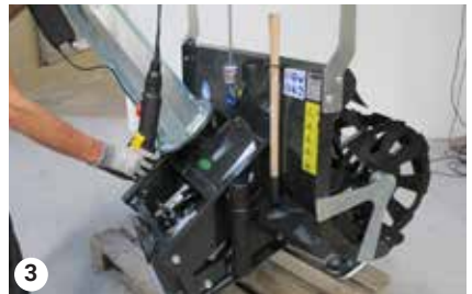
Sneslynge løftet med en kran
