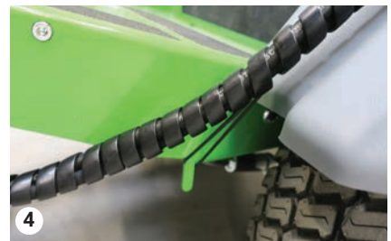
Slanger fastgøres med gummistrop
