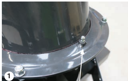
Placering af fedtnippel ved udkastertårn
