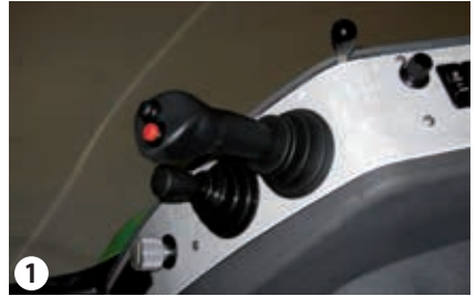
Dozerbladet hæves med joysticket
