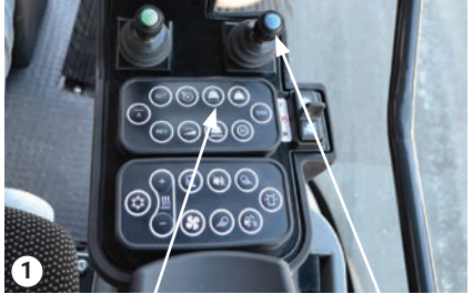
Lastaffjedring og højre joystick
