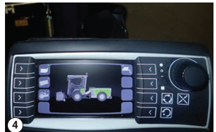
V-plov og maskine vises nu på skærmen
