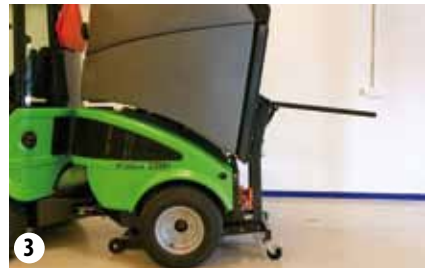
Påsætning af opsamlingstank
