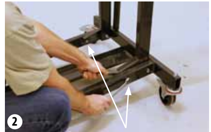
2 bolte på tankstativ
