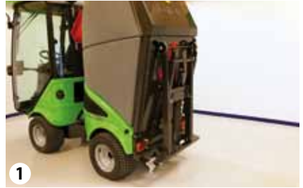
Transport af tankstativ på opsamlingstank
